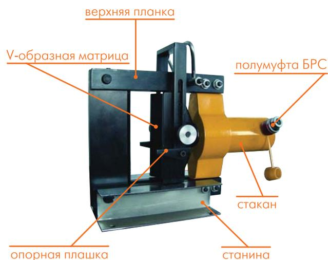
Внутри стакана смонтирован рабочий поршень с манжетой и пружина для возврата поршня в исходное положение. В стакан ввернута полумуфта быстроразъемного соединения (БРС).
