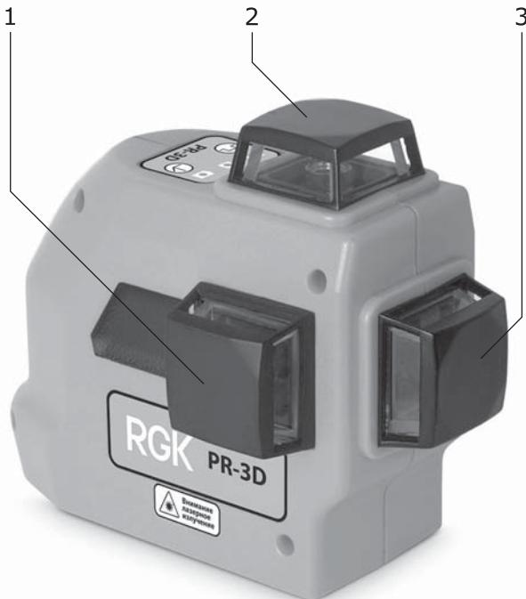
После включения прибора автоматически включается горизонтальный лазер 1. Нажмите один раз кнопку «выбор луча», включится вертикальный луч 2. Повторное нажатие кнопки включает вертикальный луч 3. Следующее нажатие активирует все три луча одновременно.
