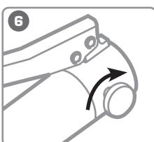
Подсоедините пресс к помпе. Поверните дроссельный винт в положение «Закрыть». Прокачайте инструмент
